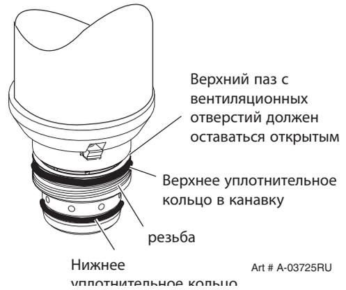
Уплотнительное кольцо головки горелки
