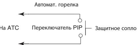
Схема цепи «детали на месте» для механизированной горелки
