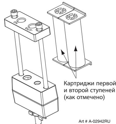
Комплект дополнительного одноступенчатого фильтра
