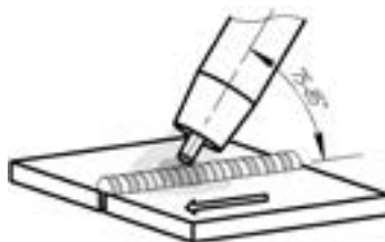
Рис. 8.5. Угол наклона горелки.
