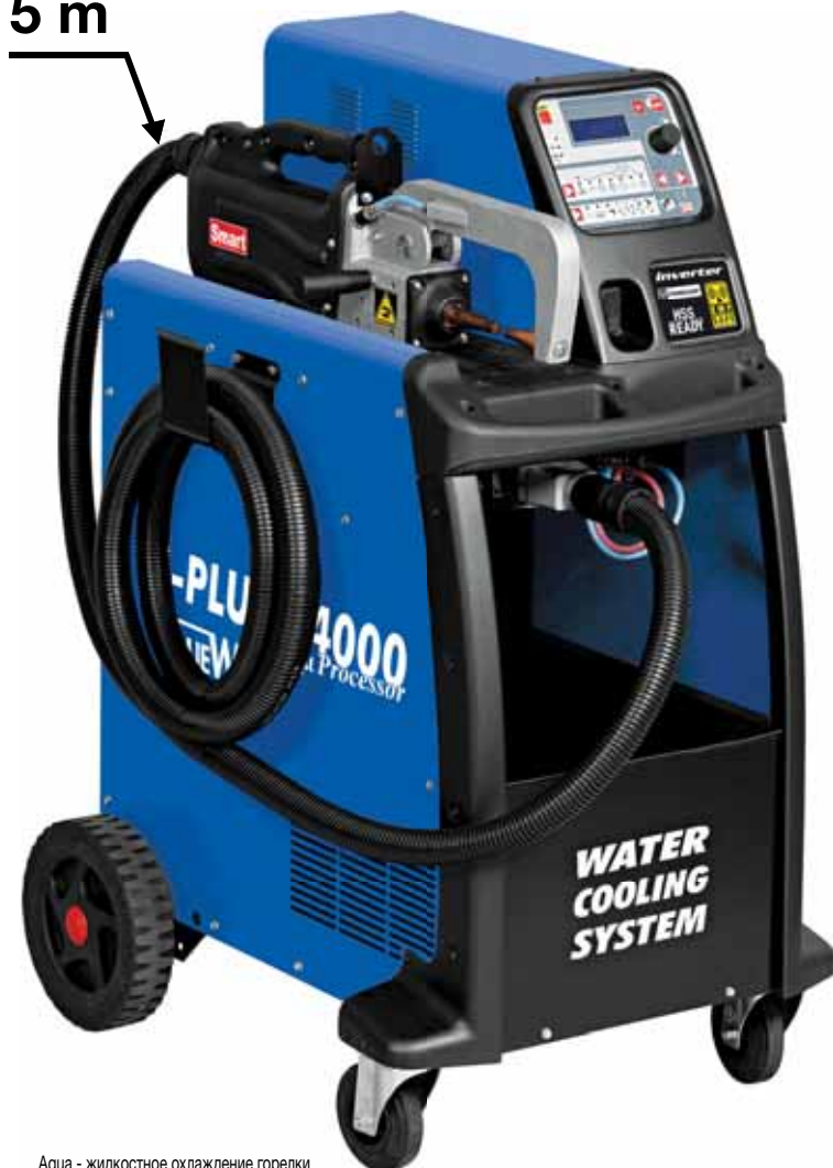
Aqua - жидкостное охлаждение горелки
