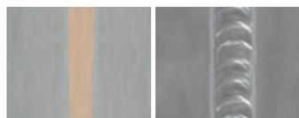
CuSi<sub>3</sub>-пайка твердым припоем    Алюминий
