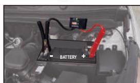
Подключается к аккумуляторной батарее транспортного средства и обеспечивает защиту бортовой электроники от перенапряжений (от скачков напряжения и сварных дуг) во время техобслуживания.
